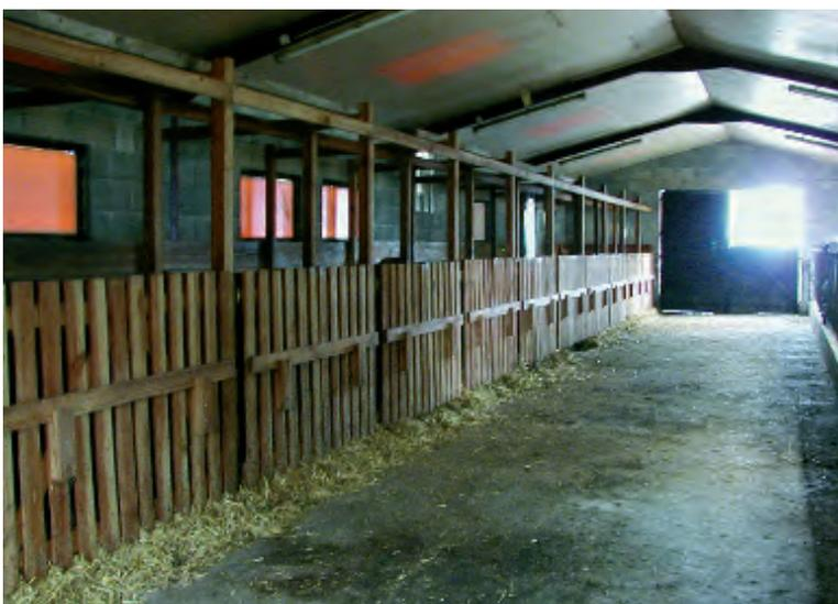
**Une salle de têtée bien isolée grâce à un faux-plafond en polystyrène extrudé**
