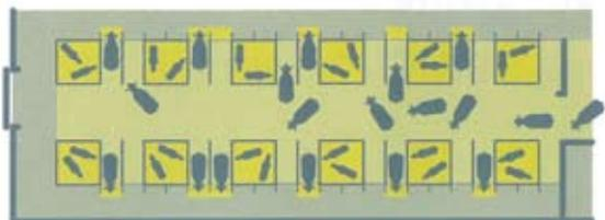
Dans la salle de tétée, des séries de deux logettes à vaches sont disposées en alternance avec des cases à veaux de deux places. Devant les logettes, des cornadis permettent de bloquer les vaches pendant la tétée. Les cases à veaux sont équipées de barrières spéciales de tétée avec 3 barres coudées réglables en hauteur et en largeur. Ainsi, il n'y a plus aucune manipulation des veaux qui restent en permanence dans leur case.
